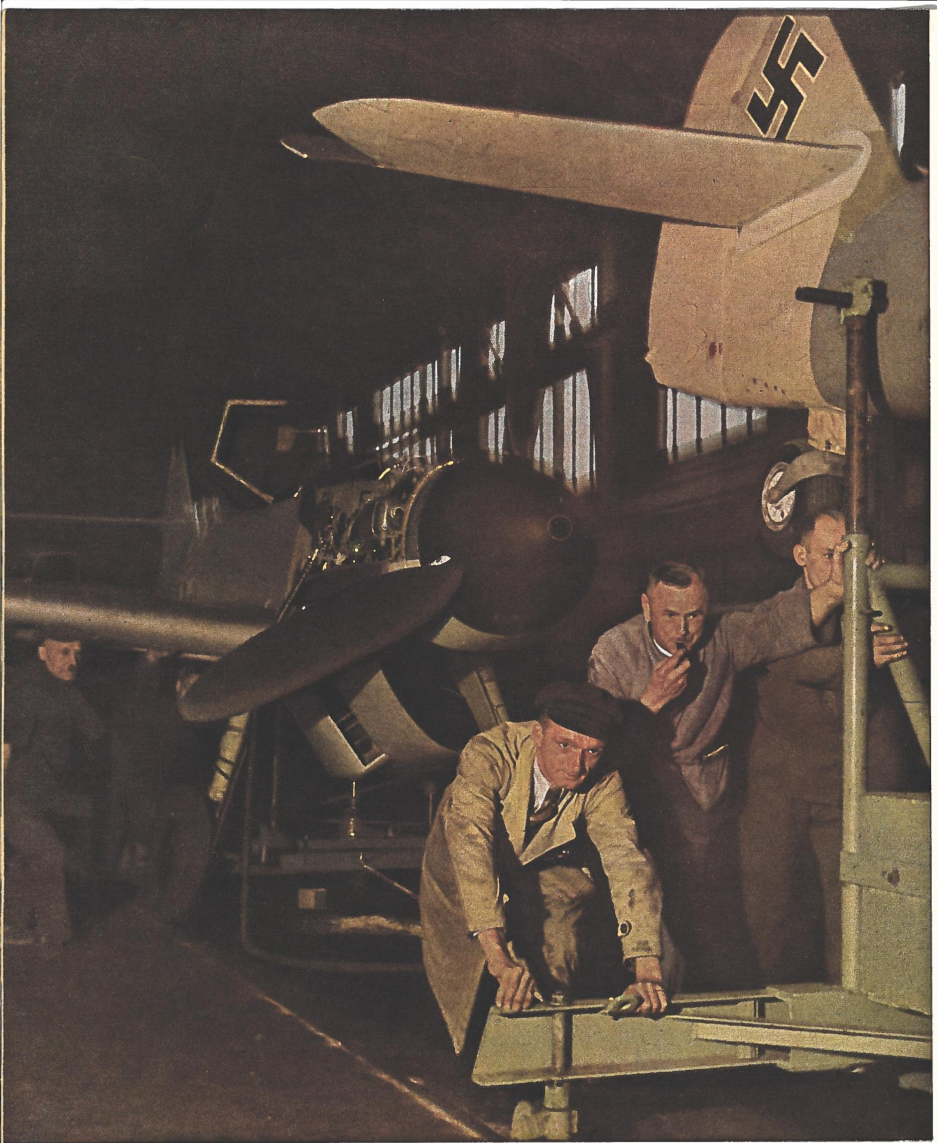
Un coup de sifflet. Aussitôt toutes les mains s'activent dans le hall de montage pour pousser dix « pas » plus loin jusqu'à la prochaine place de travail, la longue chaîne des avions de chasse, rigidement assujettis les uns aux autres par des tiges rouges-blanches. Par cette manœuvre, l'avion de fête se trouve être poussé au dehors. Il quitte la fabrique, prêt à faire son plein d'essence et son premier vol d'essai.
